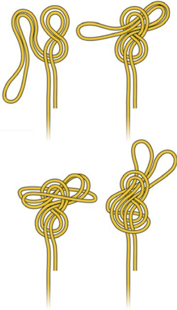
Caso particolare: isolare una parte di corda danneggiata con un nodo farfalla
